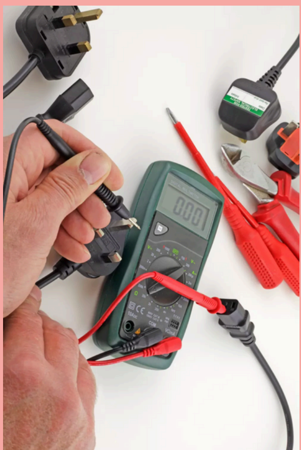
Test d'un câble d'alimentation
