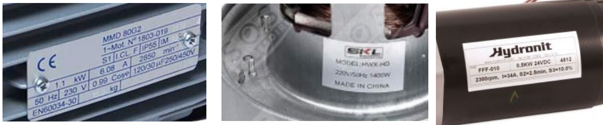
Figure 2: Plaques signalétiques, respectivement d'un moteur asynchrone, universel et à courant continu
